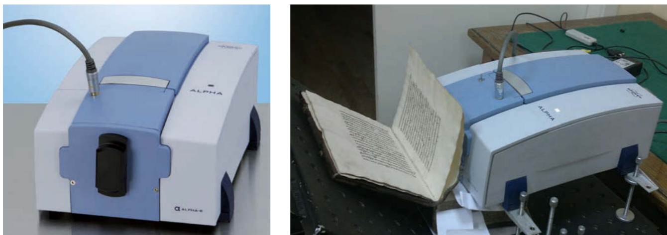
Рис. 1. ИК-Фурье спектрометр Alpha фирмы Bruker с приставкой A241/D QuickSnap™ Reflection module; а — регистрация фонового спектра с помощью специального зеркала; б — регистрация спектра отражения листа, прислоненного к отверстию прибора
