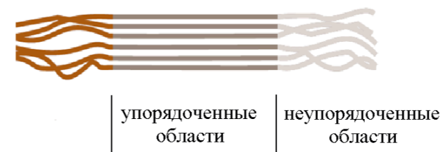
Рис. 3. Схематичное представление структуры полупорядоченного полимера одной конформации
