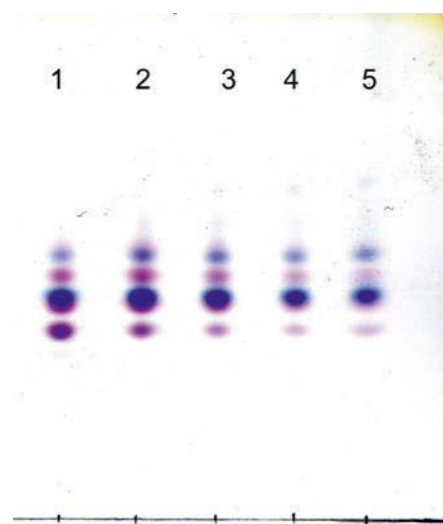
Рис. 1. Изменение хроматографических свойств пасты на основе красителей жфк и гс при термическом воздействии 200 °С: 1 — хроматограмма пробы из штриха, не подвергавшегося термическому воздействию; 2 — хроматограмма пробы штриха, подвергавшегося термическому воздействию 150 °С в течение 10 мин, 3-5 — хроматограммы проб штрихов, подвергавшихся термическому воздействию 200 °С в течение, соответственно, 2,5, 5, 10 мин
