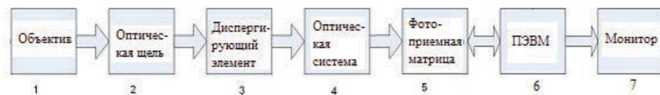
Рис. 22. Схема гиперспектрометра: 1 — входной объектив; 2 — щель; 3 — диспергирующий элемент; 4 — оптическая система; 5 — фотоприемная матрица; 6 — ПЭВМ; 7 — монитор
