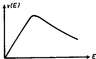
Фиг. 8.6. Средняя скорость электронов как функция напряженности электрического поля.
